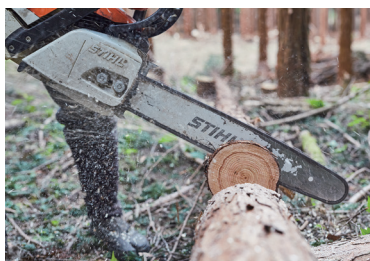
上) 由山麓沿著道路駕駛約30分鐘前往山頂神社，向山神祈求工作人員的平安。 下) 利用電鋸，把間伐後留下的絲柏木切割為方便運送的尺寸。細小的枝葉則會留在原地作土壤的肥料。
