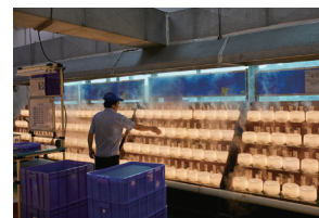
製成後的香薰噴霧器需經3小時的運作測試，確保品質後才運送至世界各地的無印良品。
