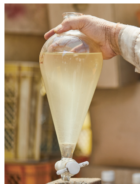
在蒸餾的過程中，帶有精油的水蒸氣將冷凝成液體狀態，靜止一段時間後，便會分離成香薰油及純露(即植物的水分)。把密度較高、沉澱於下層的純露取去，留下的便是香薰油。
