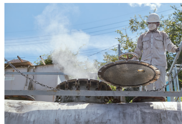
上) 蒸氣冷卻後變回液體狀態。 下) 為了製作絲柏香薰油，製作工場經反覆研究後，設計了橫長型的蒸餾器，讓工作人員製作香薰油時能一邊攪拌一邊加熱。
